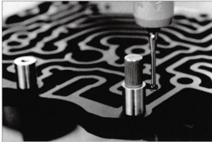
使用三次元測定螺絲孔位置
